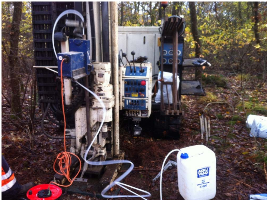
Figur 5 - Prøvetegning med inertpumpe og kontraventil.
