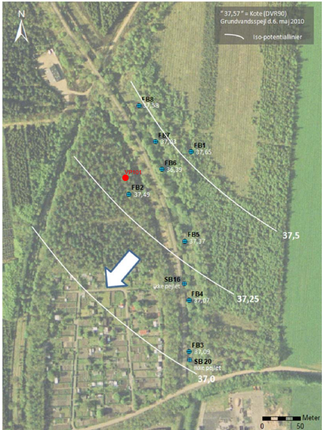
Figur 2: Placering af Geoprobe boring (VP101) til niveauspecifik vandprøvetagning.
