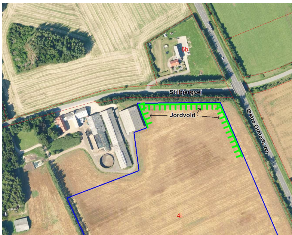
Figur 1 Graveområde angivet med stiplet blå streg, planlagt jordvold angivet med grøn streg
