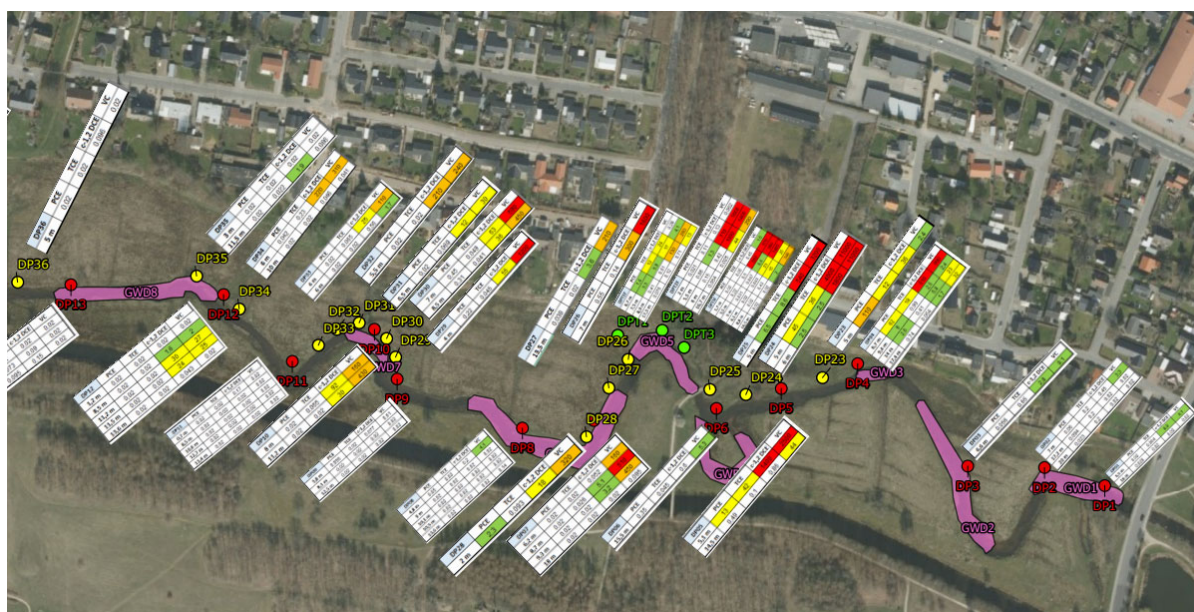
Figur 6-6: Indhold af chlorerede opløsningsmidler i de enkelte sonderinger. Koncentrationer af chlorerede opløsningsmidler er vist i rækkefølgen fra venstre mod højre; PCE, TCE, DCE, VC. Hvid farve angiver <1 µg/l, grøn 1-10 µg/l, gul 10-100 µg/l, orange 100-500 µg/l og rød >500 µg/l. Se større format i bilag 11. Bemærk, at koncentrationer anført som 0,02 µg/l betyder under detektionsgrænsen
