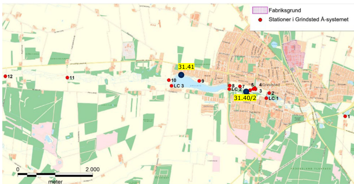
Figur 5-7 Stationer langs Grindsted Å hvor der er udført vandføringsmålinger. De sorte prikker markerer placeringen af de nye vandstandsmålerne.
