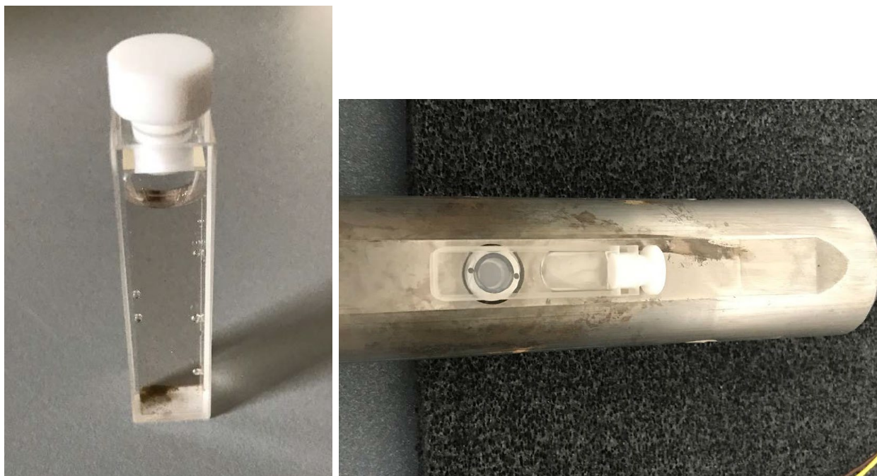
Figur 3-2 Kuvette med vandprøve til venstre, og kuvetten isat UVOST proben til højre. Fugro
