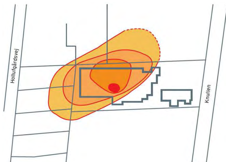
Fig. 2 Skitsen viser forureningens arealmæssige udbredelse i jorden i 4 – 11 m's dybde under Knullen 8.
